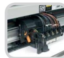
Fest eingebaute Piezo-Druckköpfe sorgen für gleichmäßige Qualität und minimale Unterbrechungszeiten
